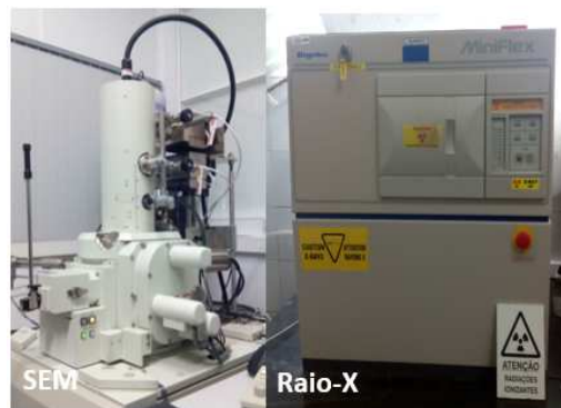
Figura 58- Equipamentos utilizados nas análises das amostras, SEM e Difractor Raios-X, respectivamente.
