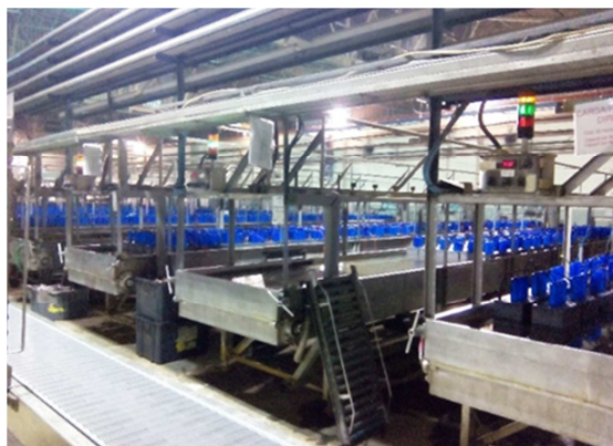
Figura 28- Mesas de carga de baterias.
