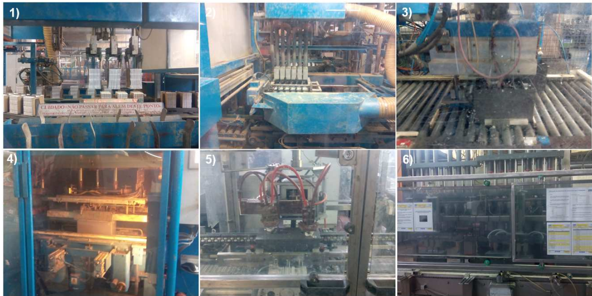
Figura 27-Linha de montagem. Legenda: 1)Colocação do jogos,2)COS,3)TTP,4)Termo-soldadura,5)Soldadura por indução, 6) Enchimento
