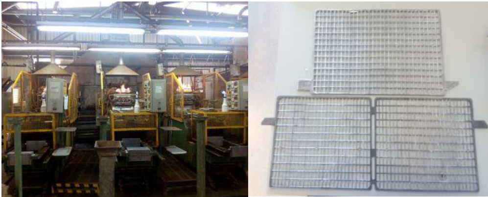
Figura 17- Linha de fundição e um exemplo de dois tipos de armadura (singular e dupla) produzida nessa Linha.
