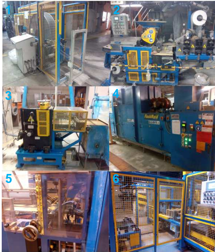
Figura 22- Linha de empastamento Conpaste : 1- Desenrolador da bobine (amaduras Concast ), 2-Empastadora, 3- Divisor (corte de pés e patilhas),4- Forno, 5- Empilhador, 6- Paletizador.
