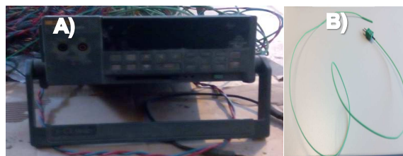
Figura 49- A) Fluke usado nos ensaios, B) sonda de temperatura.
