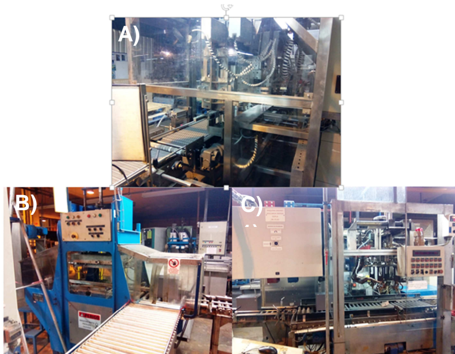
Figura 29- A) Máquina de colocar válvulas (tampões), B) Máquina de teste dieléctrico (HVT), C) Máquina de teste de descarga rápida (OCV/HRD).
